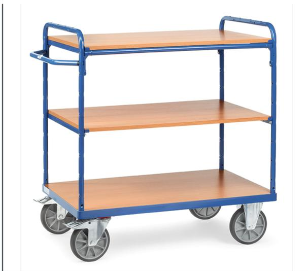
Baukasten-System: Aus Stahlrohr und Profilstahl geschweißt, pulverbeschichtet blau RAL 5007, Schraubkonstruktion. Stirnwände offen. 1 fester und 2 lose Einlegeböden aus Holzwerkstoffplatten, Oberfläche Buchendekor. Einlegeböden variabel einsetzbar, Teilung 100 mm. Tragkraft pro Einlegeboden 90 kg. 2 Lenk- und 2 Bockrollen, TPE-Bereifung, Naben mit Rillenkugellager. Feststeller an den Lenkrollen, gemäß der Europäischen Norm EN 1757-3 (Sicherheit von Plattformwagen).
